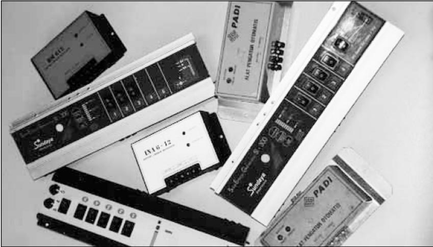
**Abbildung 9:** Lokal in Indonesien produzierte Solarladeregler im Test am Fraunhofer ISE
