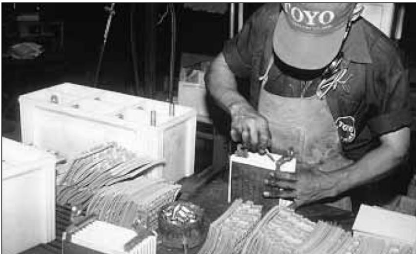
**Abbildung 4:** Lokale Batterieproduktion bei BATEBOL in Bolivien
