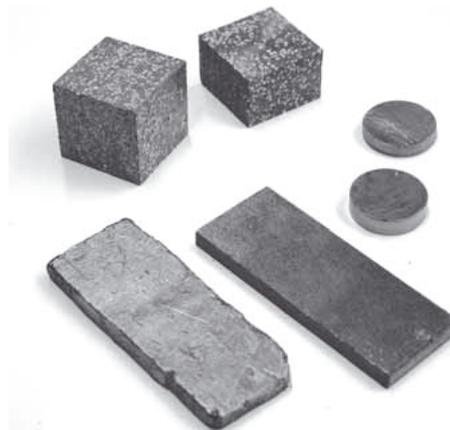
Abbildung 5 Ausgewählte Formkörper von Latentmaterialien aus Salz/Graphit
