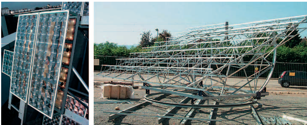
Abbildung 8 a) Außentest von FLATCON (Fresnel Lens All-glass Tandem CONcentrator)-Modulen b) Aufbau eines 5 kW-Zweiachsenleichtbau-trackers am Fraunhofer ISE in Freiburg
