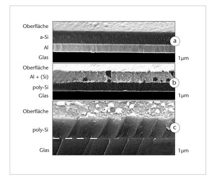
Abbildung 4 a-b-c Ionenstrahlmikroskopaufnahme einer Glas/Al/a-Si Strukur im Querschnitt: (a) vor und (b) nach der thermischen Behandlung für 1 Std. bei 500°C. (c) Rasterelektronenaufnahme nach Aluminiumätzung, die den zusammenhängenden poly-Si-Film zeigt. Die Proben in (a) und (b) sind um 45° gekippt, die in (c) um 20°, der Maßstab ist demnach nur in horizontaler Richtung korrekt. Die weiße Strichlinie in (c) dient der Grenzflächenvisualisierung.
