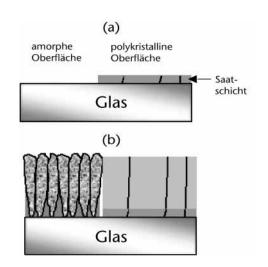
Abbildung 3a und 3b Schematische Darstellung der Niedertemperaturdeposition von Silicium auf amorphe und polykristalline Oberflächen. Die rechte Hälfte des Glassubstrates ist mit einer großkörnigen poly-Si-Saatschicht bedeckt.
