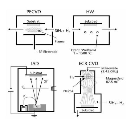
Abbildung 2 Prinzipieller Aufbau der diskutierten Depositionsmethoden.
