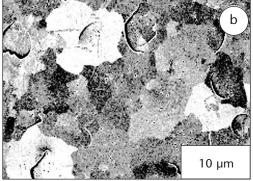
Abbildung 5 Orientation Imaging Microscope (a) und Elektronen-Channeling-Kontrast Aufnahme (b) zur Korngrößenanalyse der früheren Glas/poly-Si-Grenzflächen (a) einer bei 450°C und (b) einer bei 475°C kristallisierten Probe. In (a) sind die dunkelgrauen Gebiete in die (111) und (110)-Richtung orientiert. Die mittelund leichtgrauen Körner weisen (100)-Orientierung auf. Drei Körner sind exemplarisch indiziert. Die weißen Gebiete haben Orientierungen, die in keine dieser drei Kategorien fallen.
