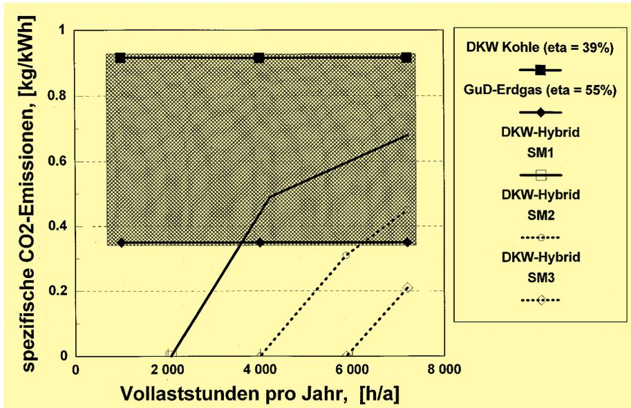
Abbildung 3: Spezifische CO<sub>2</sub>-Emission eines solarthermischen Dampfkraftwerks und Bandbreite fossiler Referenzanlagen (exemplarisch erstellt für ein Parabolrinnenkraftwerk mit 80 MW Nennleistung an einem Standort mit einer jährlichen Einstrahlung von 2.000 kWh/m<sup>2</sup>a, qualitativ jedoch gültig für alle hybriden Dampfkraftwerkskonzepte).
