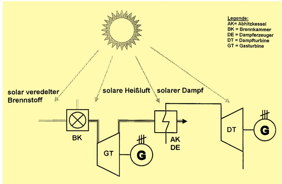
Abbildung 2: Optionen der solaren Energieeinspeisung bei hybriden Solarkraftwerken: solare Wasser-/Dampfeinspeisung, solare Heißluftspeisung, solar veredelte Brennstoffeinspeisung, am Beispiel einer Gas- und Dampfturbinenanlage
