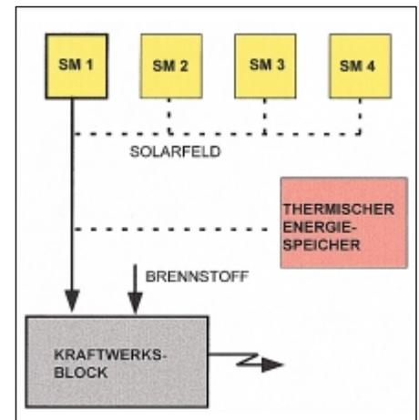
Abbildung 1: Grundkonfiguration hybrider solarthermischer Kraftwerke (SM 1 – solar multiple – kennzeichnet eine Solarfeldgroe, die den Vollastbetrieb der Anlage zu 100% mit Sonnenenergie erlaubt)
