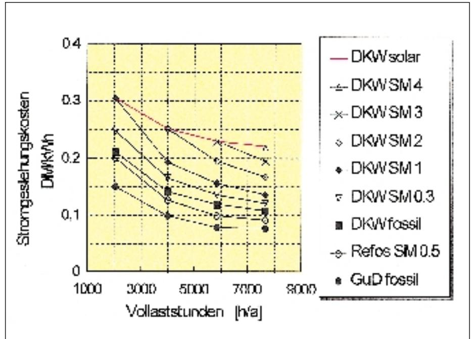
Abbildung 5: Stromgestehungskosten solarthermischer Hybridkraftwerke (DKW: Dampfkraftwerk; SM 1: solar multiple; Refos: GuD-Kraftwerk mit solarer Luftvorwärmung; GuD: Gas- und Dampfturbinen-Kraftwerk)
