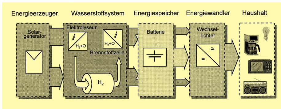
Abbildung 12: Schema des elektrischen Energieversorgungssystems des Energieautarken Solarhauses
